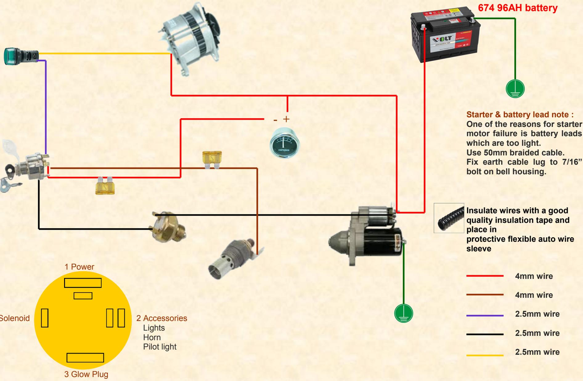
**Agriline Diesel** Massey Ferguson 35 Wiring Diagram
